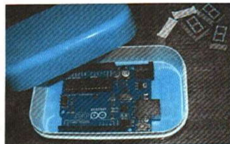
Рис. 3. Корпус для электронного блока (из мыльницы).
