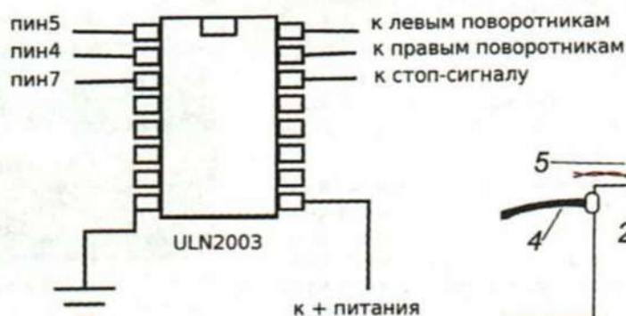
Рис. 5. Схемы подключения поворотников и стоп-сигнала к Arduino.
