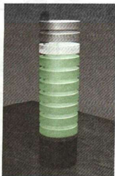
Рис. 1. 3D-модель светового индикатора уровня звука.
